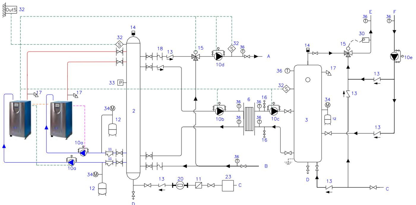
• **Схема системы контуров отопления**
