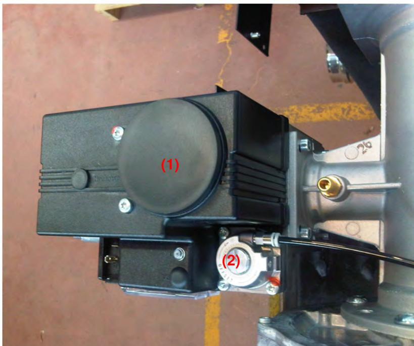
Сначала снимите крышку и открутите винт внутри:
