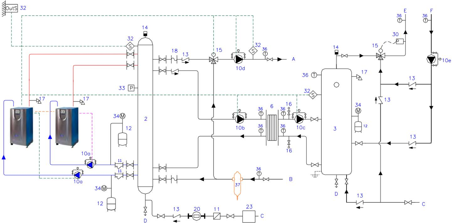
• **Схема подключения к реконструируемой системе: контур отопления**
