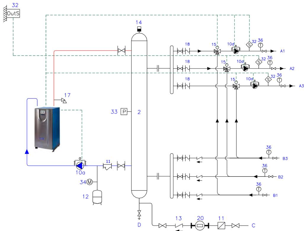
b) Электрическая схема: 1 котел с 3 отопительными контурами:
