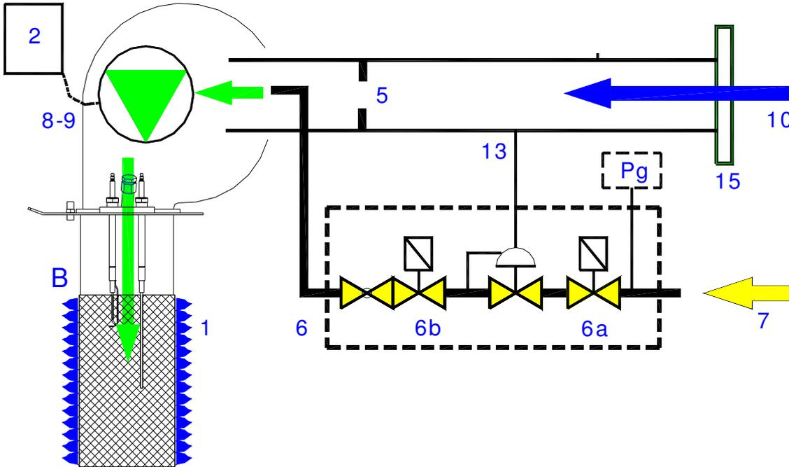
5. Вентури обеспечивает смешивание газа и воздуха в нужной пропорции при работе на любой нагрузке котла. При движении воздуха в трубе Вентури образуется разрежение, которое обеспечивает подачу газа (7) от газового клапана (6). Этот процесс выступает в качестве дополнительной защиты: при отсутствии воздуха не будет подачи газа.
