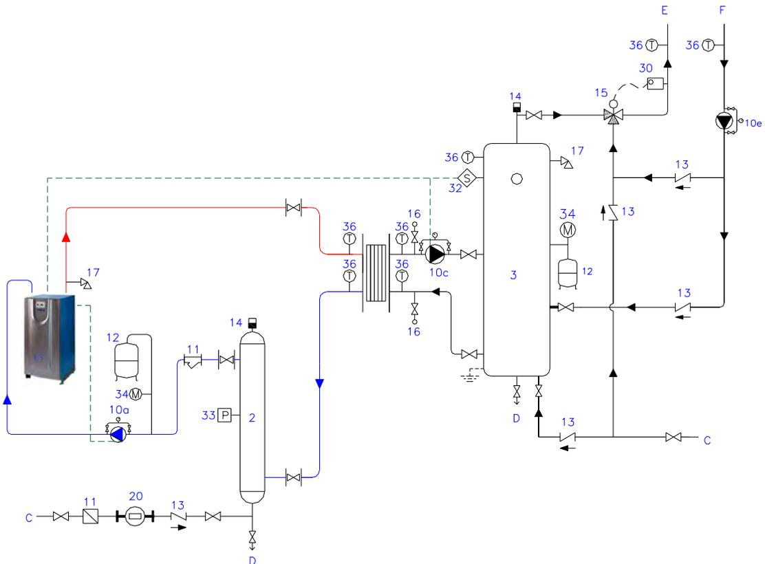
• **Схема системы: контуры ГВС и отопления**
