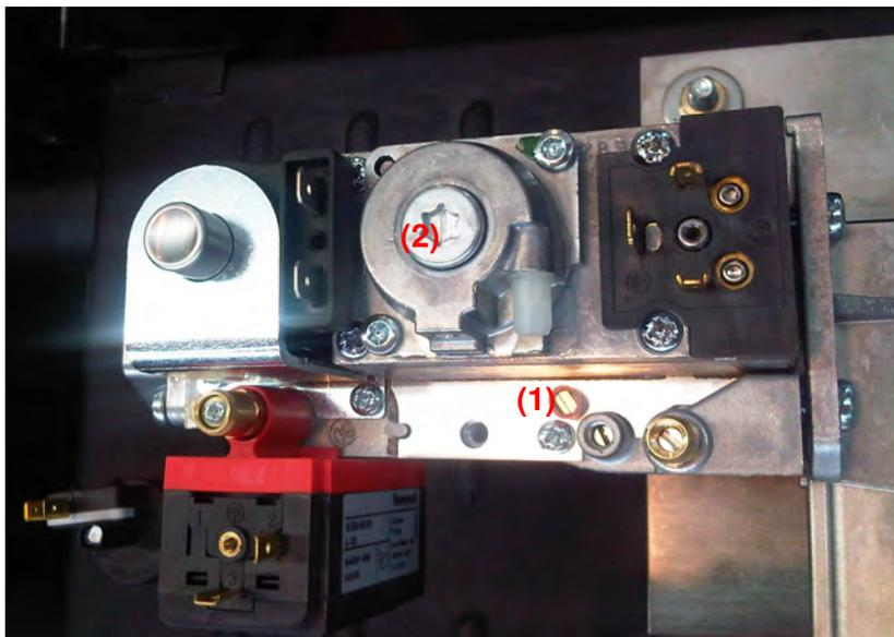
Сначала снимите крышку и поверните винт под ней:
